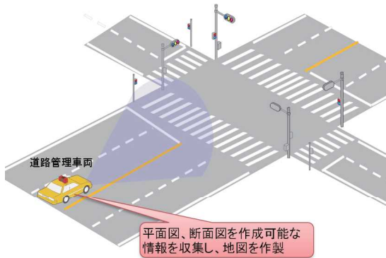
図-1 道路面上の主要地物の位置情報（緯度・経度及び標高）を走行車両から取得するイメージ
