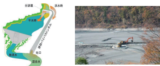
図-1 堆砂対策の事例 (ダム貯水池土砂管理の手引き(案)より)
